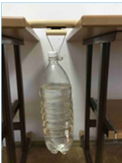
Různé způsoby zatěžování suchého zipu
